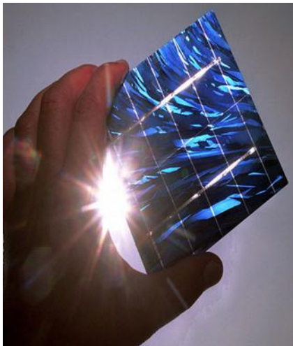
Kristalline Solarzelle Foto: BMU/ Copyright: H.-G. Oed
